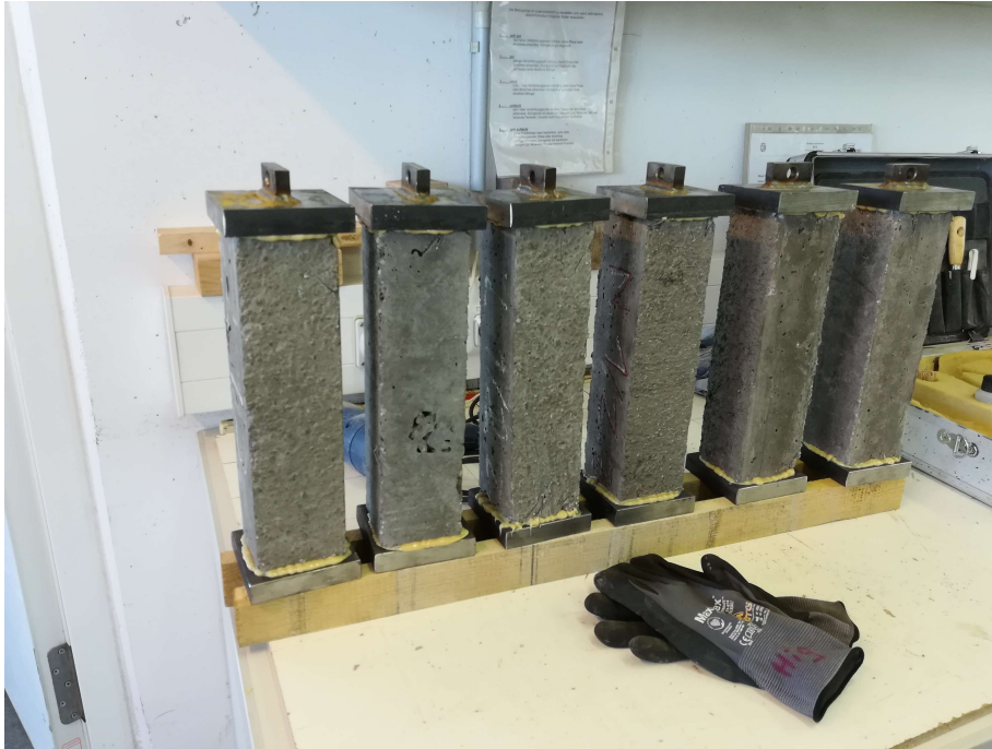
Messung der axialen Zugfestigkeit, mit aufgeklebten Stahlplatten.
