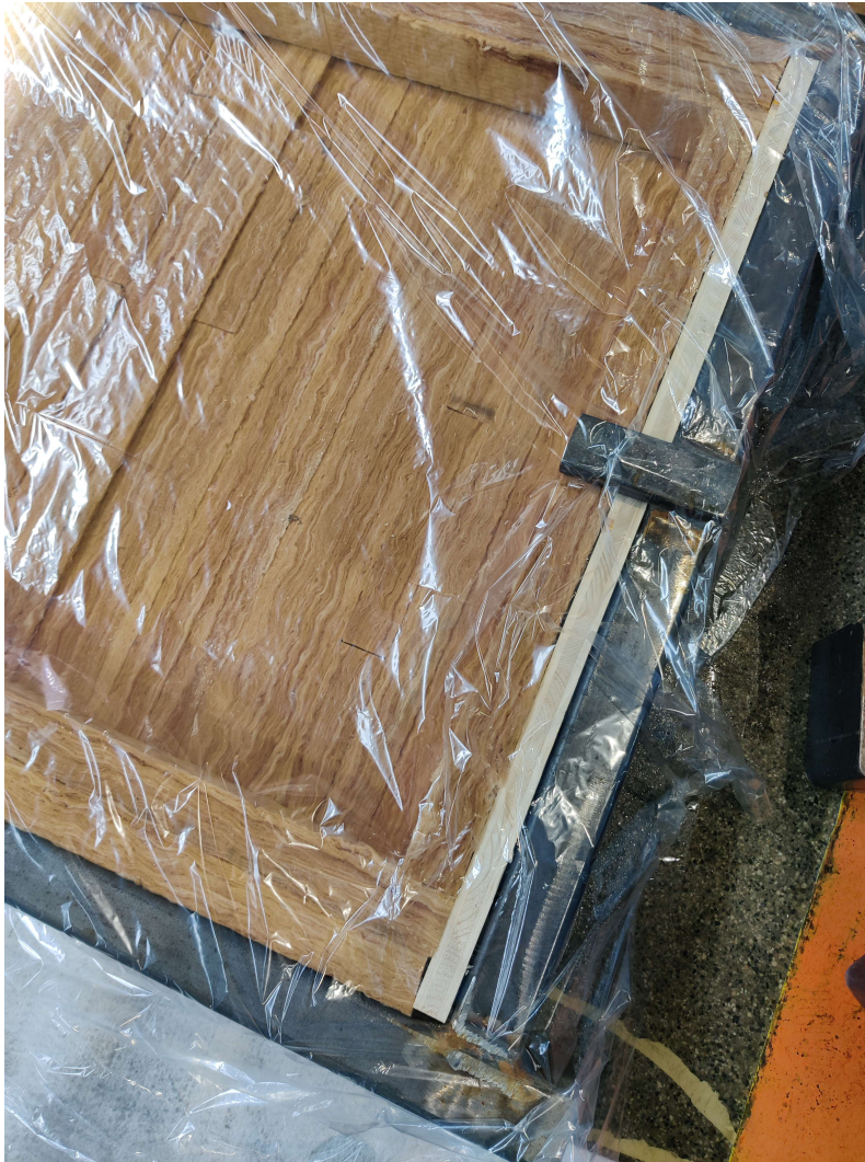
Schalungsende mit Formrohr zur des Längenmessgerätes
