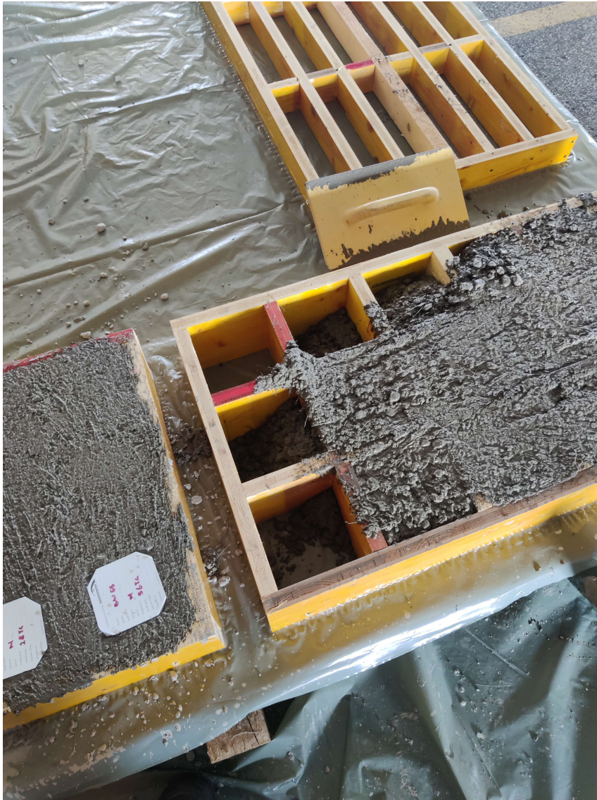
Schalung für die Probekörper
