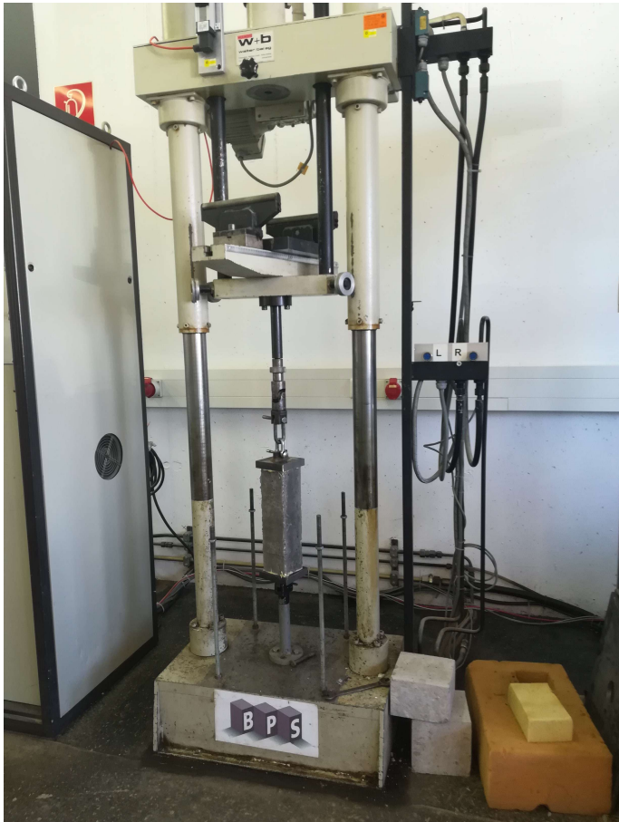
Messung der axialen Zugfestigkeit, mit aufgeklebten Stahlplatten.
