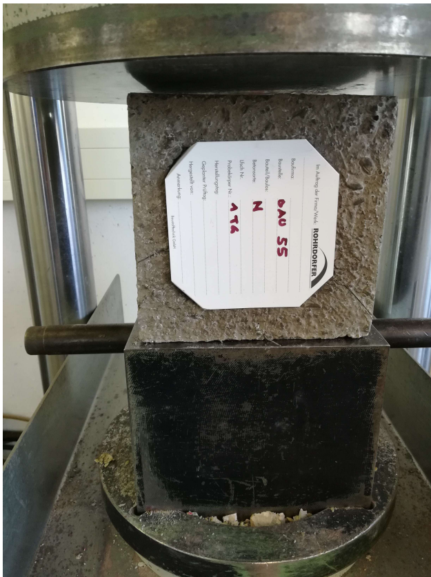
Messung der Druckfestigkeit, ... ist Standard.
