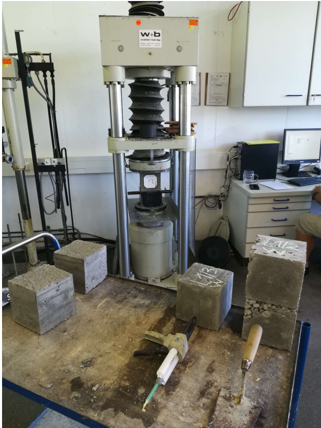
Messung der Druckfestigkeit, ... ist Standard.
