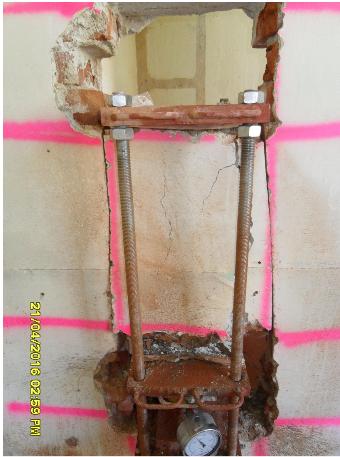
Prüfkörper nach dem Abdrücken.
